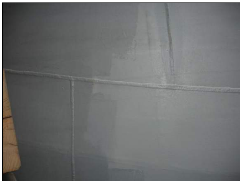
Figura 6.53. . Chapa del forro exterior de un buque de acero soldada por el proceso SAW.
