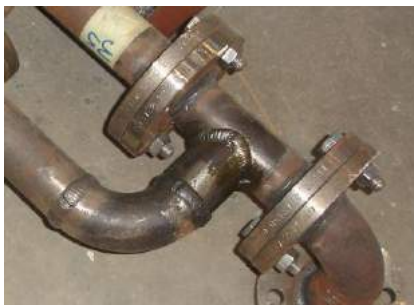
Figura 6.2.5 Unión en ángulo de tubería.
