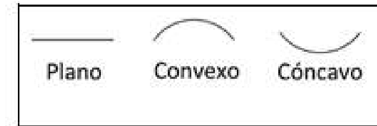
Figura 3.9. Indicación del contorno de la soldadura.
