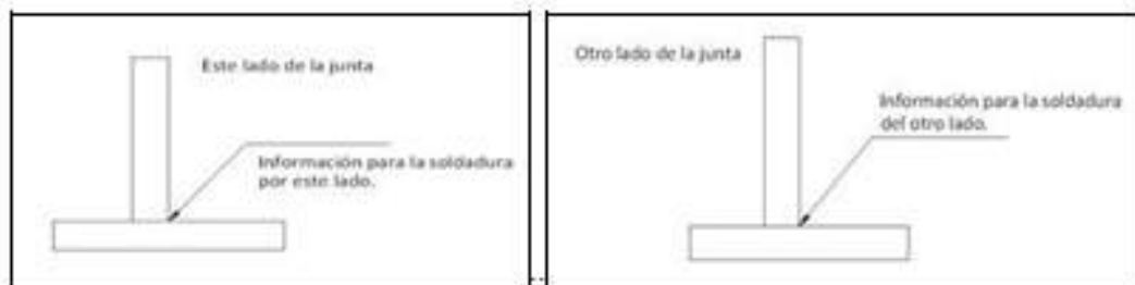
Figura 3.3. Indicación del lado a realizar la soldadura.
